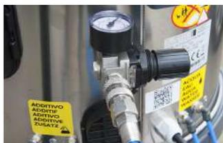
Macchina multifunzione: pulizia con detergente, vapore, vapore con detergente, schiuma e acqua calda. Dotato di attacco per aria compressa e manometri per aria e vapore. Autonomia illimitata del vapore grazie all'alimentazione elettrica della caldaia controllata elettronicamente.
